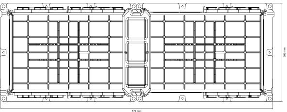
Abbildung: Doppelschalungskasten (E-No: 372733939)
